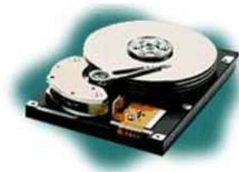
Винчестерский накопитель со снятой крышкой корпуса
